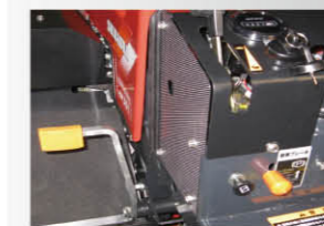
ステップ左側に、フットブレーキを配置 (ABタイプ)
