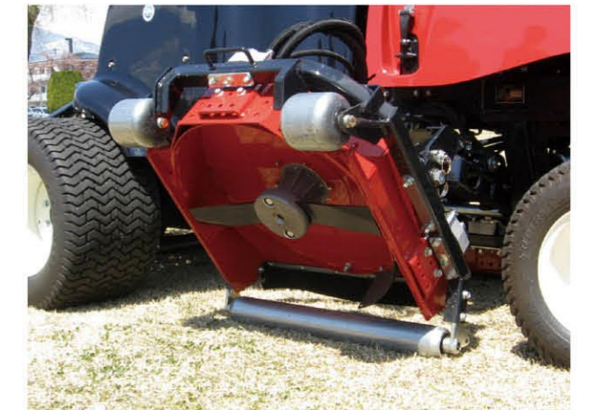
フリップアップ機構 刃の状態が確認できて、メンテナンス性が良い
