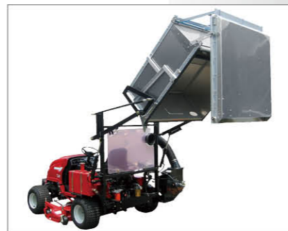
ハイダンブVS700SG (ホッパー容量: 700ℓ、ダンブ高さ: 1.6m)
