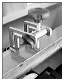
センター・ネジでベッドナイフを押す (作業しやすいように取り付け台を回転させて縦位置にしています。)
