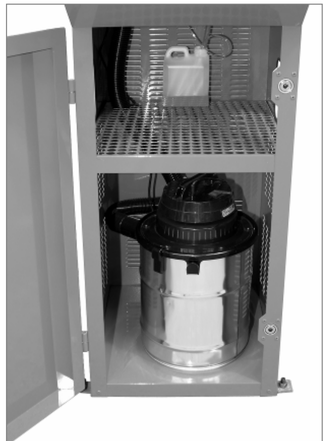
図 2.5 キャビネット内部： クーラントとバキューム
