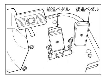
本機を前進させるには前進ペダル、後進させるには後進ペダルを踏み込みます。 この本機には、クラッチペダルはなく、ペダルの踏み具合(強弱)により速度を上げたりできます。
