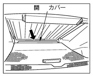
ラジエータに芝草などが付着していると、 オーバーヒートの原因となります。作業前、作 業後には必ず点検・清掃してください。作業 条件によっては作業中にも点検してください。
