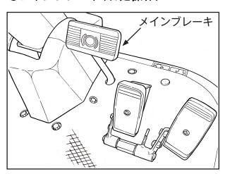
本機を停止させるときに使用します。 ペダルを踏むことでブレーキがかかります。 また、始動安全装置が付いていますから、 始動時には必ず踏んでください。
