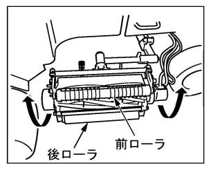
・元の姿勢にもどす場合は、エンジンを始動して昇降レバーを上昇側に操作しリールユニットが地面より浮き上がった位置で、昇降レバーを下降側に操作すると、ラッピング時の姿勢になります。
