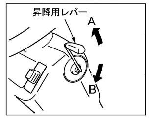
モアを上下させるには、昇降レバーをAの方向に動かすとモアは上昇して、Bの方向に動かすとモアは下降します。
