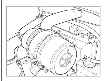
アウターエレメントは 100 時間毎に掃除、6 回掃除の後には交換してください。ホコリの多い所で作業するときは、もう少し短い間隔で掃除してください。規定時間内になっていなくても 1 年間でエレメントを交換してください。
