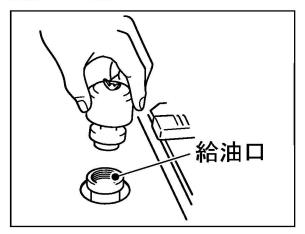
後カバー、前カバーを開けます。油圧タンク 上部のフタを固定しているボルトをゆるめる とフタが外れます。給油後、元通り締め付け てください。
