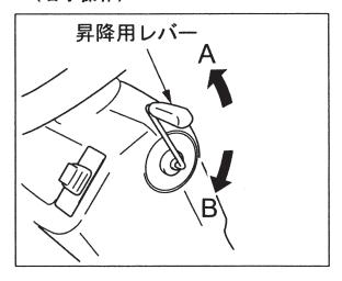
作業機を昇降するときに使用します。 A の方向に動かすと、作業機が上昇します。 B の方向に動かすと下降します。
