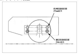
刈り高さが34mm以上の場合は、ブラケットを 下側の位置で固定してください。(納品時の取り 付け位置)
