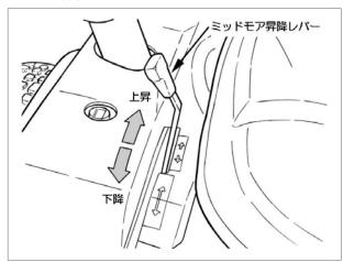
レバーを後方に倒すと上昇し、前方に倒せば下降します。レバーから手を離すと自動的に中立位置に戻ります。ミッドモアを下降する場合は、 昇降レバーを前方に1秒間保持してください。 (リフトチェーンがたるむまで)
