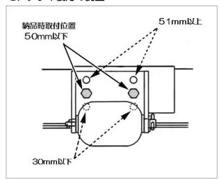
刈り高さに応じて 3 段階でアンチスカルプローラの取り付け位置を変えてください。
