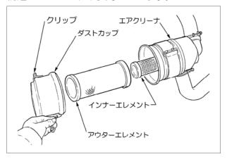
アウターエレメントは 100 時間毎に清掃、6回 掃除の後には交換してください。ホコリの多い所で作業するときは、もう少し短い間隔で掃除してください。規定時間になっていなくても1年間でエレメントを交換してください。
