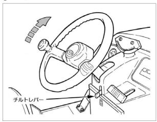
ハンドル角度を調整できます。チルトレバーを 引くとハンドル位置を自由に調節できます。 位置が決まったらチルトレバーを前方にして 固定してください。また、走行中での調節は行 なわないでください。
