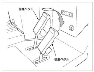
本機を前進させるには前進ペダル、後進させるには後進ペダルを踏みます。この機械にはクラッチペダルはなく、ペダルの踏み具合(強弱)により速度を上げたり下げたりできます。 走行ペダルの踏み具合で発進時の速度が違いますので、発進時にゆっくり踏み込んでください。
