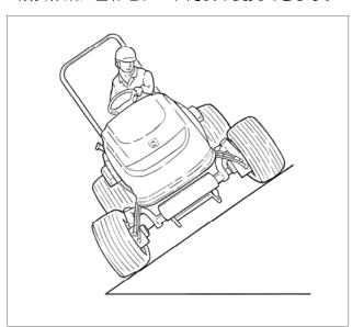
オイルタンク上部のシートスイングレバーを握ると、シートが左右に 12.5°と 25°の2段階にローリングします。等高線の連続作業時に使用することにより、楽な姿勢で安全な作業が行なえます。
