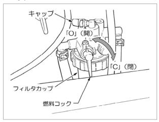
この機械の燃料フィードポンプは、カムシャフトからの駆動で作動していますので清掃・交換などの作業をした後のフィルタカップ内のエア抜きは、キャップを外しエア抜きを行なってください。
