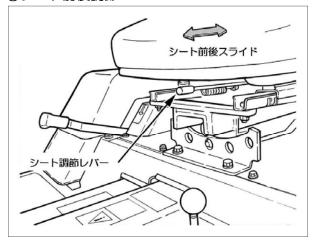
レバーを動かすと前後にスライドします。 作業ポジションに適した位置に調節してくだ さい。
