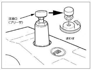
ブリーザを反時計方向に回すとブリーザは外れます。給油後、ブリーザを締め込んでください。
