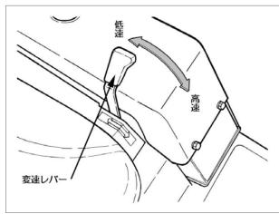
本機の車速を作業内容に合わせて「L」低速(4駆)・「H」高速(2駆)の2通りに選ぶことができます。前側に倒すと高速に、後側に倒すと低速になります。通常の作業では低速側にしておき、高速側を使用するのは移動するときだけ使用してください。変速するときは本機を停止させてから行なってください。
