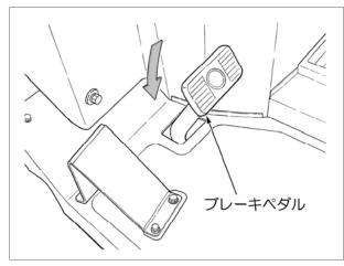
ブレーキペダルを踏むことでブレーキがかかります。また、始動安全装置が付いていますので、始動時には必ず踏んでください。
