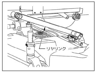
(5) ユニバーサルジョイントの本機側ピンを外し、 ジョイントを後方にスライドさせてください。
