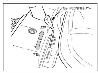
ミッドモアを上下させるには、昇降レバーを前方 後方に倒すとモアは下降して、後方に倒すとモア は上昇します。上昇・下降後レバーから手を離す と自動的に中立位置に戻ります。
