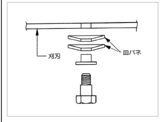
上図のように取り付けてください。皿バネの方向に注意してください。(凹部を刈刃側にする) 刈刃の取付ボルトは下表に従い締め付けてください。
