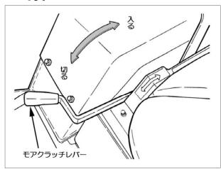
モアクラッチレバーを「入」にすると刈刃が回転します。「切」にするとクラッチが切れ刈刃の回転が停止します。
