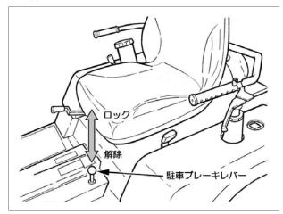
ブレーキペダルをいっぱいに踏み込み、レバーを引き上げると駐車ブレーキが働きます。 解除するときは、ブレーキペダルを踏み込み、 レバーを押し下げながらブレーキペダルを離す と解除されます。
