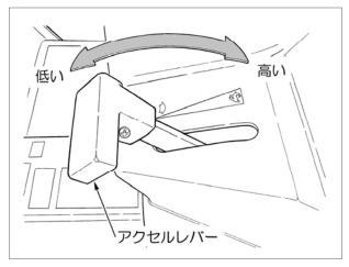
エンジン回転を速くしたり、遅くしたりするのに使用します。レバーを手前へ引くと、エンジン回転が低くなります。レバーを前へ押すと、エンジン回転が高くなります。
