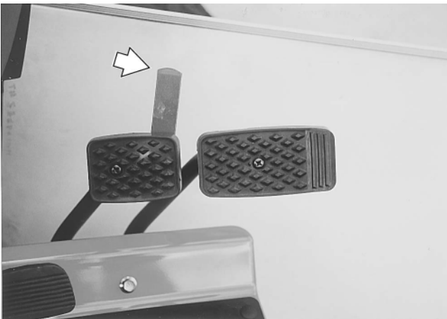
図15 ブレーキペダルのロック（連結板）
