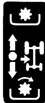
MID・PTO操作レバー 部品番号-390173891 位置-左側フェンダの上
