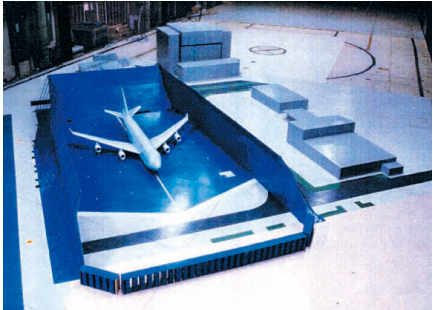
航空機試運転設備の空力・音響模型試験
