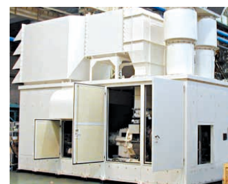
ガスタービン防音パッケージ
