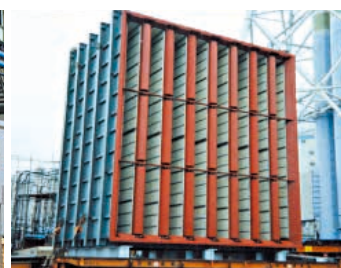
発電設備ファン用消音器
