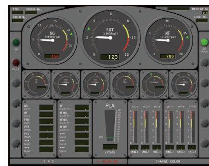
エンジン計測制御コンソール画面
